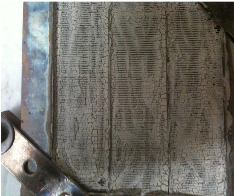
図1-10 連続サイクル実験後におけるモジュール外観
