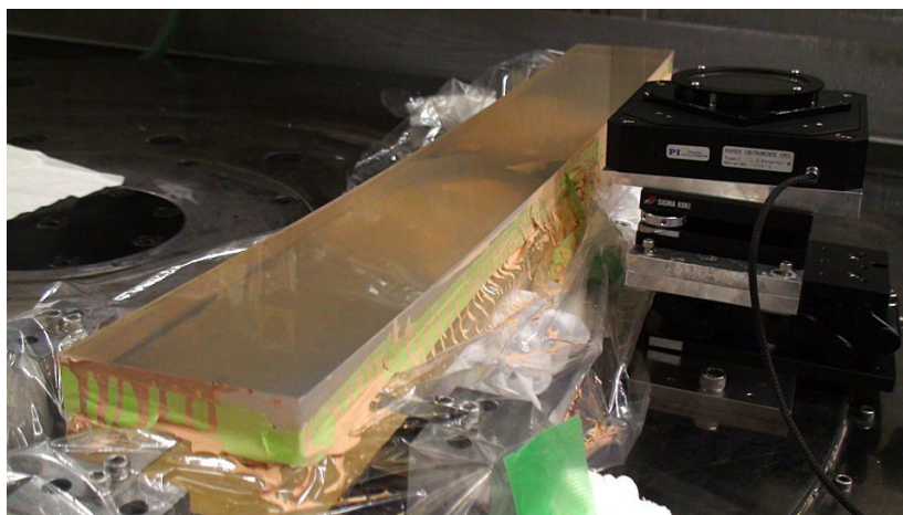
図 4.11 上図：曲率基準鏡は 3.8m 主鏡の網掛け部分に相当する表面形状を持つ。下図：研削・研磨加工を終えた曲率基準鏡。写真右端は参照面と位相シフト・位置調整用のステージ。
