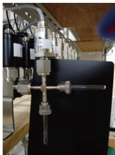
Fig. 1-b. Graphitization reactor 図 1-b. グラファイト化反応器
