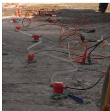
図 3.3-1 地盤改良前後で行った浅層レーリー波探査の計測地点
