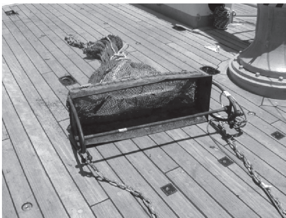
陸棚上の生物調査に使われる生物ドレッジ。15 分ほど海底を曳くと豊富な生物が採集される。
