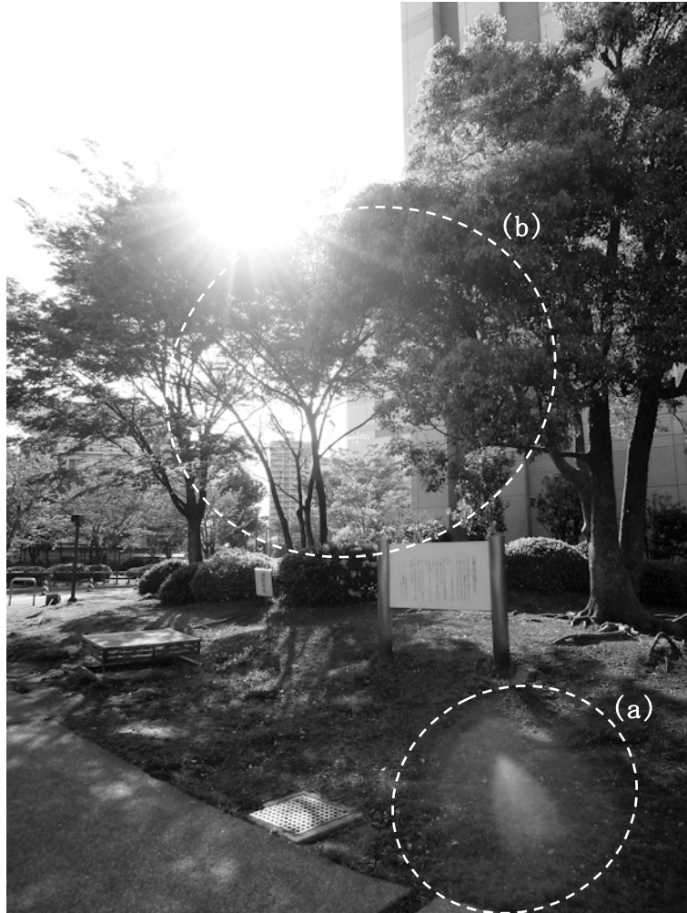
図 1 写真撮影時に発生するゴーストおよびフレアー ((a) ゴースト, (b) フレアー)
