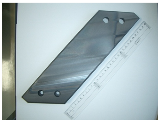
図 1.5 LHD の炭素ダイバータ板 (IG-430U) の写真.
