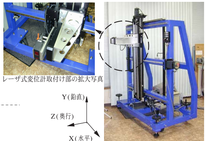
写真-6 レーザ式表面形状計測装置
