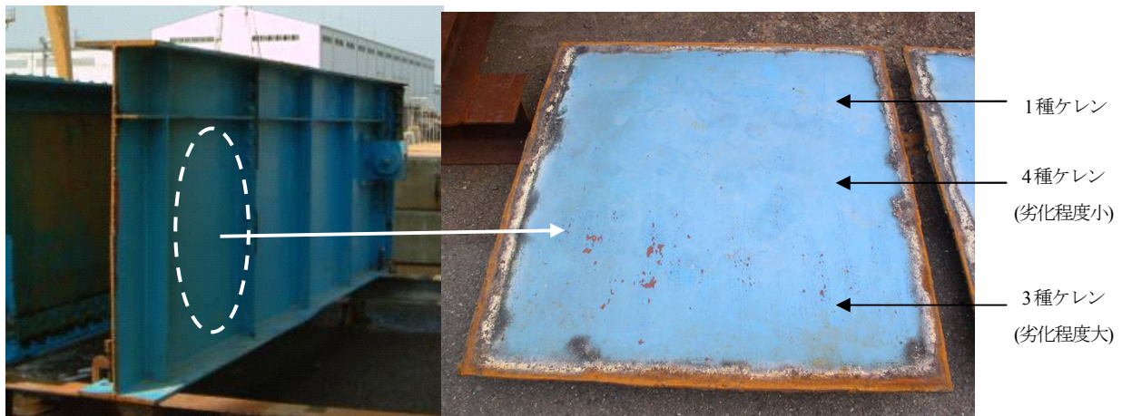
図-2 撤去した鋼桁の外観と切り出して使用したウェブの表面状態と適用した素地調整
