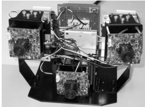
図 A3-3 ヒューマノイド(HRP-2P)用ステレオカメラシステム
