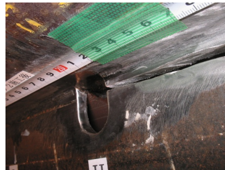
(a) ディスクグラインダーによる切込みの施工 (b) スリットと観察孔の施工状況
