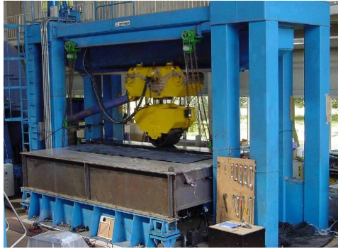
図-2.8 輪荷重走行試験機
