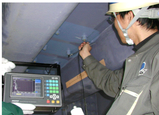
図-3.1 超音波(手動)探傷によるデッキ進展き裂の調査状況
