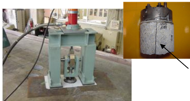
図-4.10 引張試験载荷装置と試験後の円形コア
