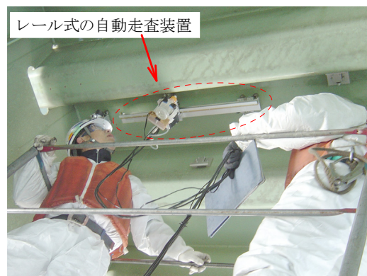
図-3.23 実橋鋼床版での探傷の様子
