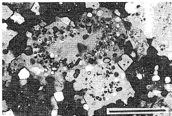
写真3 正長石斑晶と真珠状縁。自破碎アダメロ岩質斑岩 I06。直交ニコル。バーの長さ：0.2 mm。
