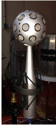
図 1.2: 剛球バッフル型アレイ (mh acoustics 社)
