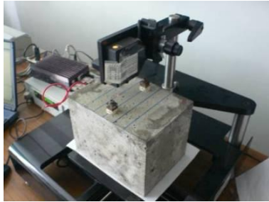
写真-2 レーザー変位計での測定状況
