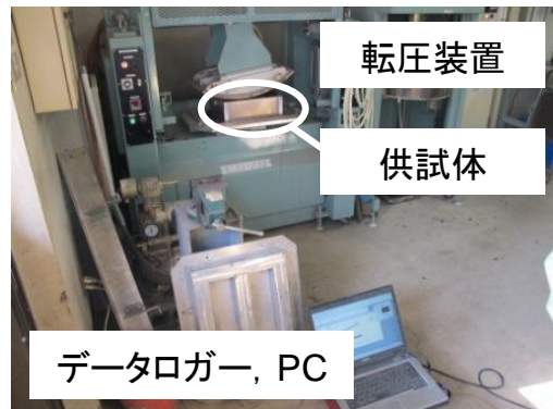
写真 - 2 アスファルト転圧時の状況
