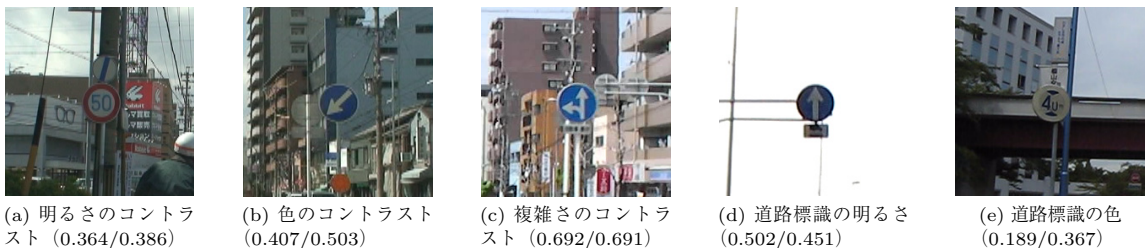
図 8 道路標識の視認性を低下させる要因 (視認性評価値の真値/提案手法による視認性推定値)
