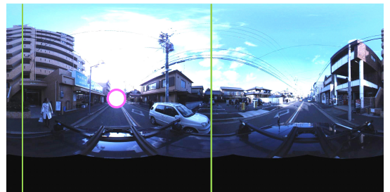
図 8 Lady-bug3 から得たパノラマ画像 Fig. 8 Panorama image obtained from Lady-bug3.
