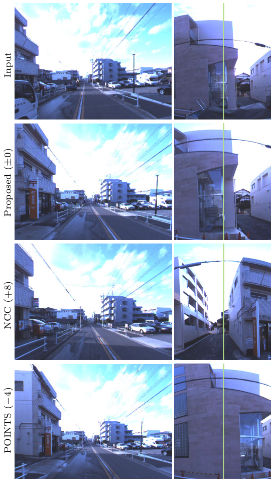
図 11 図 10 と同じ系列のあるフレームに対する各手法の対応付け結果の例。左図は正面向きカメラ映像、右図は図 8 の左側方部分の画像及び道路方向と垂直な位置の線、括弧内の数字は正しい対応フレームからのずれを示す。
