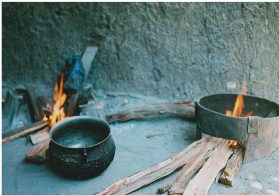
写真 11-1. 三ツ石カマド(左)と改良カマド(右)
