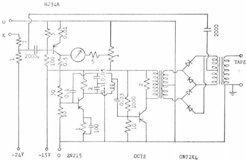
Fig. 2 Main part Resistance :  $K\Omega$  Capacitance :  $\mu F$
