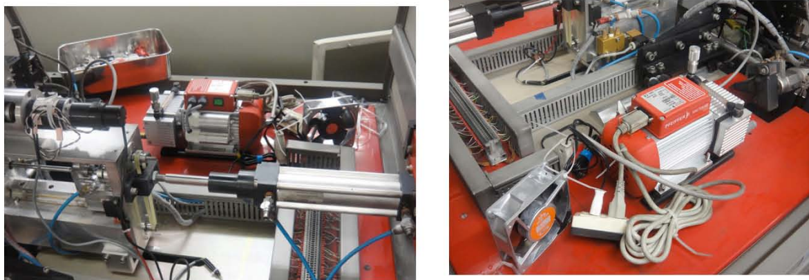
写真 1 イオン源のステージに設置されているダイヤフラム真空ポンプが金属音を発して故障した。
