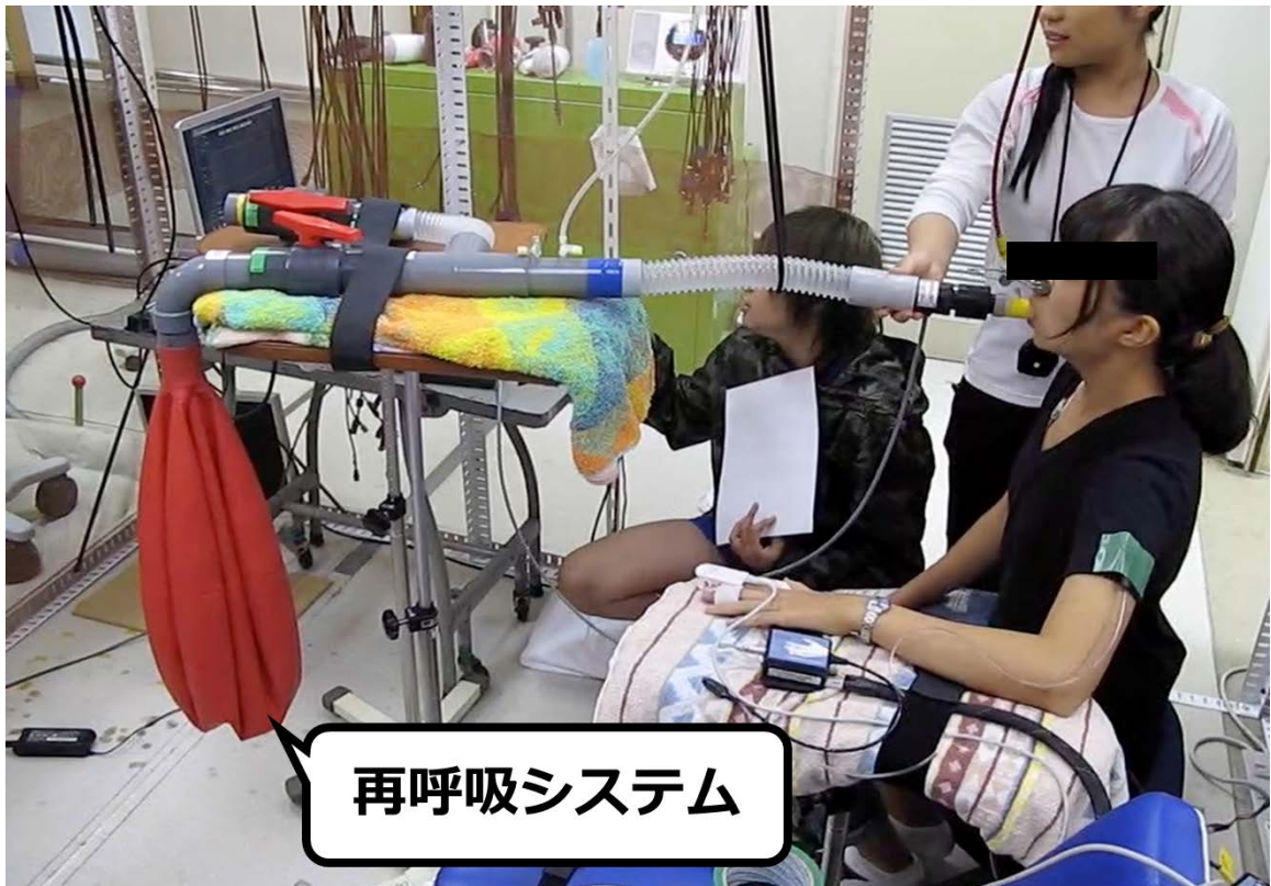
図 6. 呼吸筋持久力テスト時に用いた再呼吸システム.
