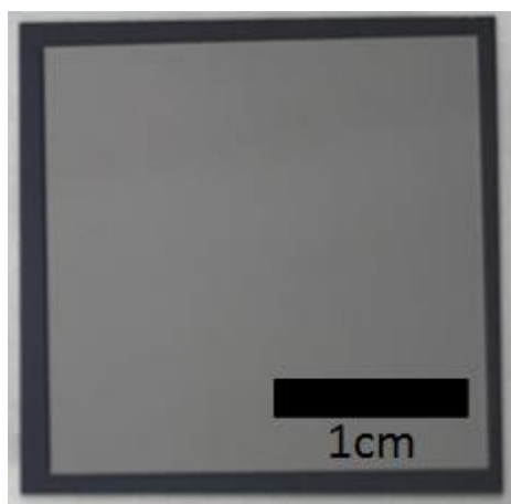
図 4-4 ペースト印刷後の Si 基板外観写真
