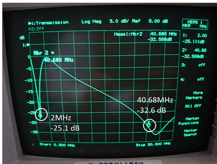
図 2-11 RF 補償ラングミュアプローブの周波数透過特性
