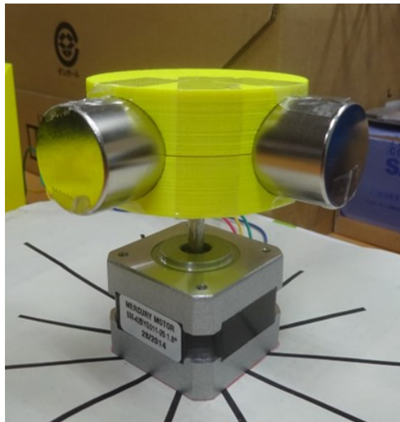
図 4.30: L 字型に磁石を配置した回転磁石マーカ
