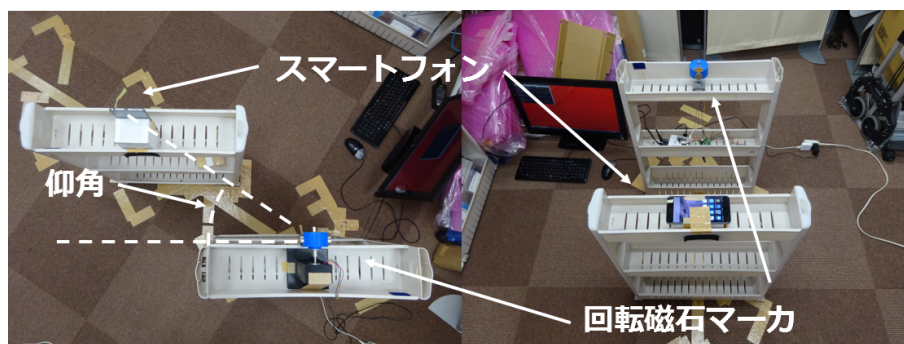
図 4.15: 仰角 \psi 推定の実験の様子, (左) 仰角 \psi = 30^\circ 時の推定, (右) 仰角 \psi = 0^\circ 時の推定
