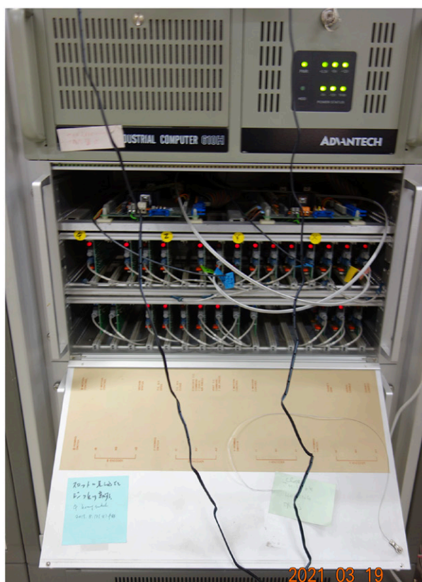
図6 パソコンから加速器部分を制御するための信号を伝達する光ケーブル。 左側：装置のおもて面、右側：装置の裏面
