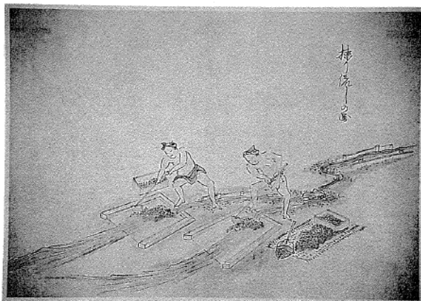
Picture of the Hida-Kanayama Mine. 飛騨かなやま絵図「掬り流し」 「飛騨かなやま絵図」は、安政5(1853)年2月、高山役所の地役人指田織之助孝勝によってえがかれたもので、22枚の絵図とそれぞれの説明より構成されている。採鉱から製錬までのすべての工程が見事に描写され、当時の鉱山の実態を良く伝えている。
