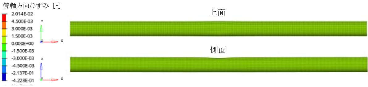
図-3.14 解析モデルに形成したデント外観 (API 5L L415, デント深さ : 6%)
