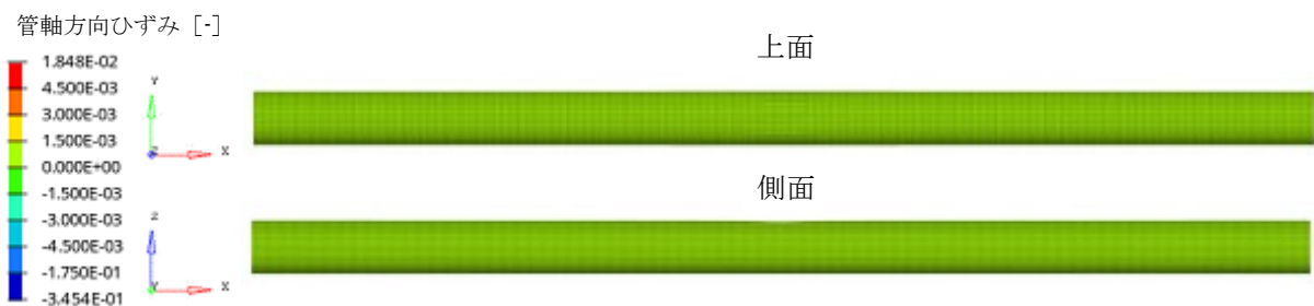
図-3.8 解析モデルに形成した面状デント外観 (SGP, デント深さ: 3%)
