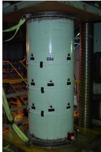
図-2.8 健全管の実験状況
