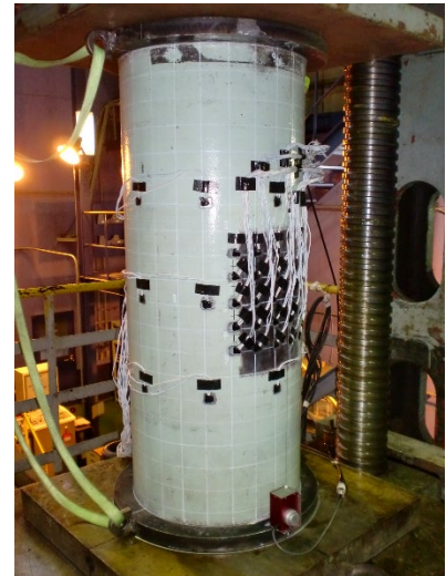
図-2.9 デントを有する鋼管の 実験状況
