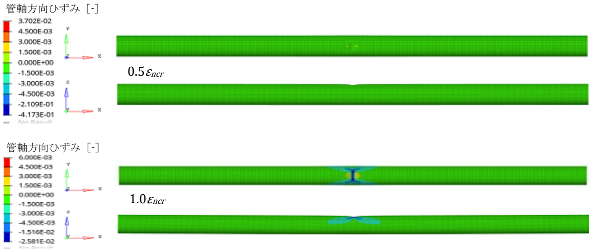
図-3.43 付図1 軸ひずみ分布図 (SGP, 線状デント: 深さ 6%, 内圧無し, 埋設条件未考慮)
