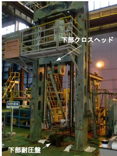
図-2.7 軸圧縮座屈実験装置 (5000kN 万能試験機)
