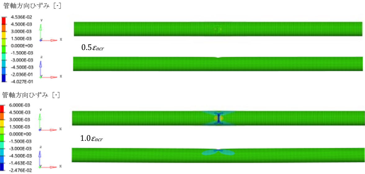
図-3.45 付図1 軸ひずみ分布図 (SGP, 線状デント : 深さ 6%, 内圧あり, 埋設条件未考慮)
