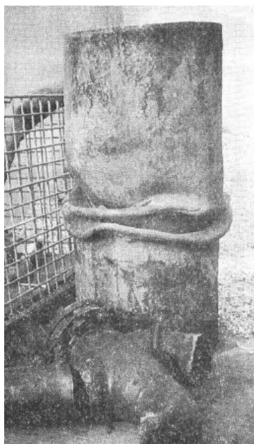
図-1.4 米国・サンフェルナンド地震（1971年2月）で座屈した鋼管（16インチ）
