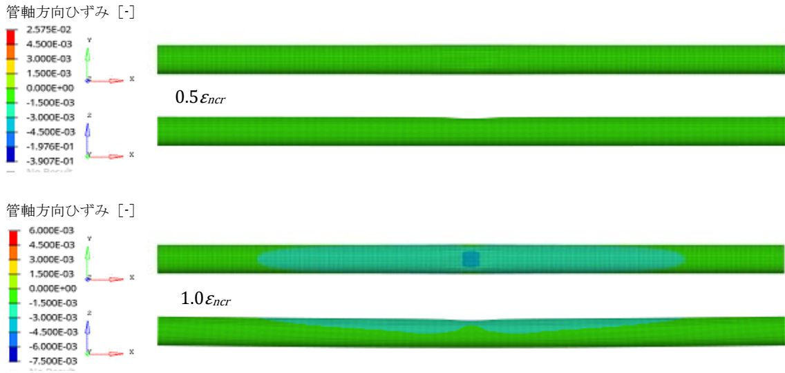
図-3.20 付図1 軸ひずみ分布図 (SGP, 面状デント : 深さ 6%, 内圧あり, 埋設条件未考慮)
