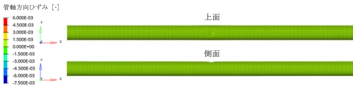
図-3.39 解析モデル上に形成した線状デント外観 (API 5L L415, デント深さ : 6%)
