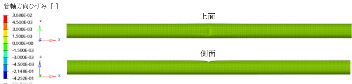
図-3.35 解析モデルに形成した線状デント外観 (SGP, デント深さ : 10%)
