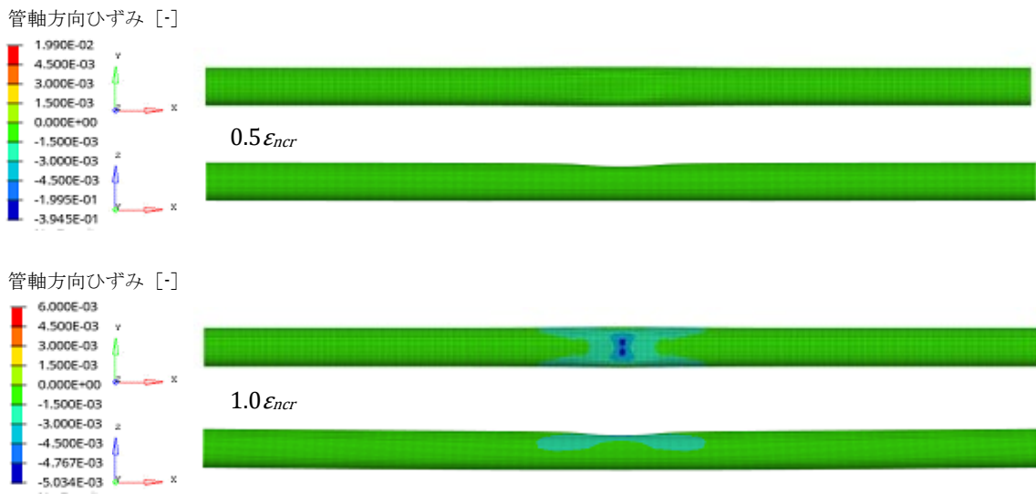
図-3.20 付図2 軸ひずみ分布図 (SGP, 面状デント : 深さ 10%, 内圧あり, 埋設条件未考慮)
