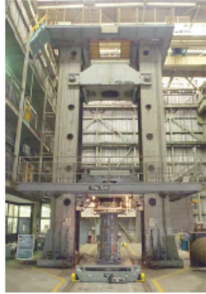
図-2.20 鋼管の軸圧縮実験装置 (10MN 構造試験機)
