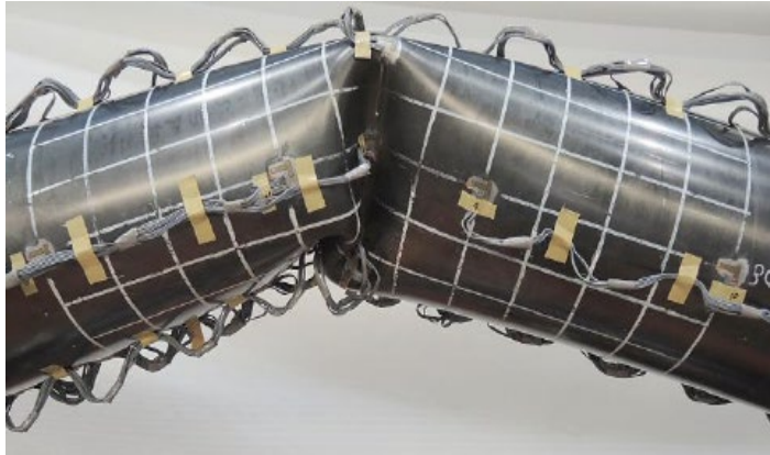
図-4.22 デント部の変形状況（供試体 3）（実験終了時）
