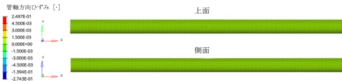
図-3.33 解析モデルに形成した線状デント外観（SGP，デント深さ：3%）
