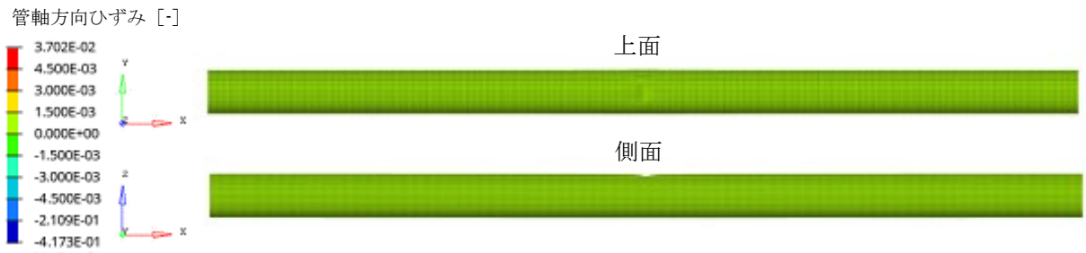
図-3.34 解析モデルに形成した線状デント外観 (SGP, デント深さ : 6%)
