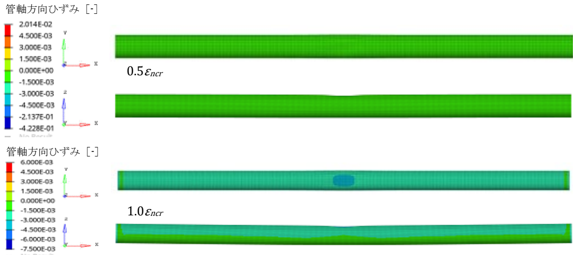
図-3.19 付図1 軸ひずみ分布図 (API 5L L415, 面状デント: 深さ 6%, 内圧無し, 埋設条件未考慮)
