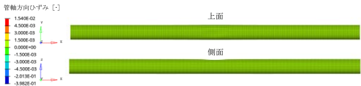
図-3.9 解析モデルに形成した面状デント外観 (SGP, デント深さ: 6%)
