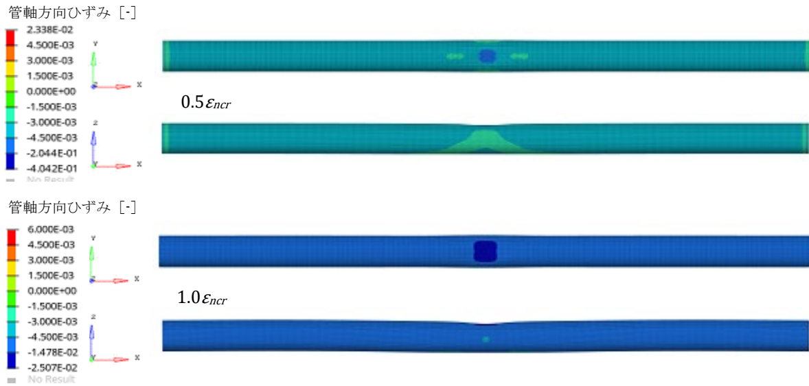
図-3.25 付図1 軸ひずみ分布図 (API 5L L415, 面状デント: 深さ 6%, 内圧, 埋設条件を両方考慮)
