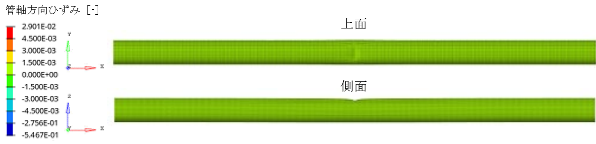
図-3.40 解析モデル上に形成した線状デント外観 (API 5L L415, デント深さ : 10%)
