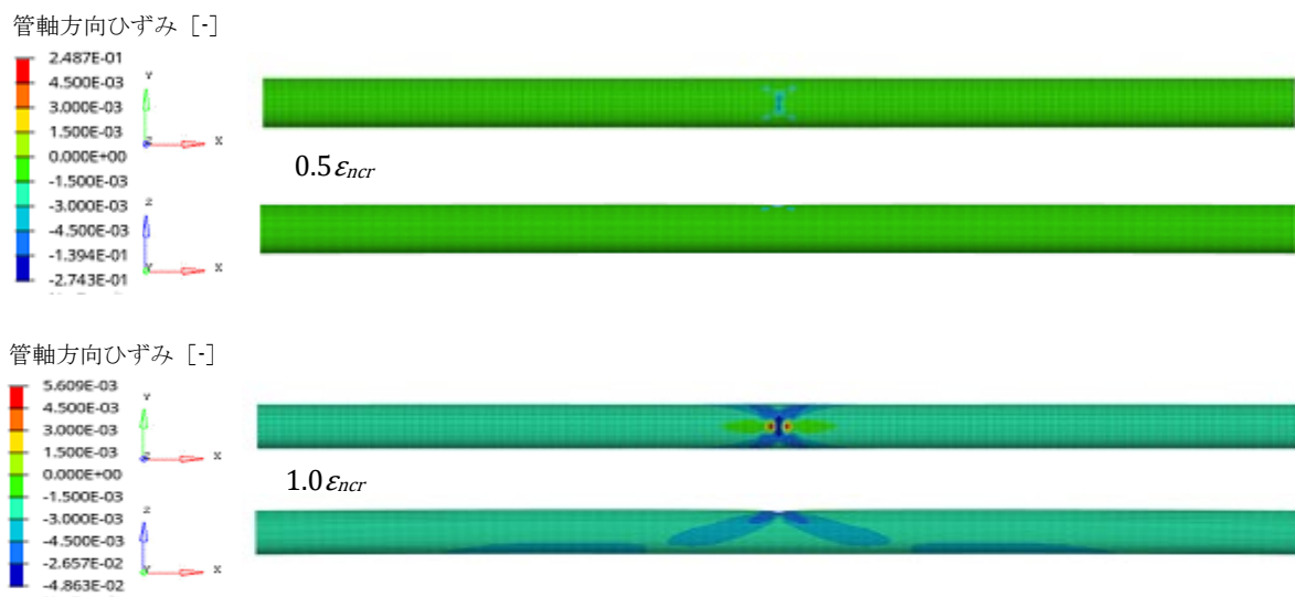
図-3.43 軸ひずみ分布図 (SGP, 線状デント : 深さ3%, 内圧無し, 埋設条件未考慮)
