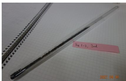
写真1：鉄試料と助燃剤を詰めて排気した石英反応管
