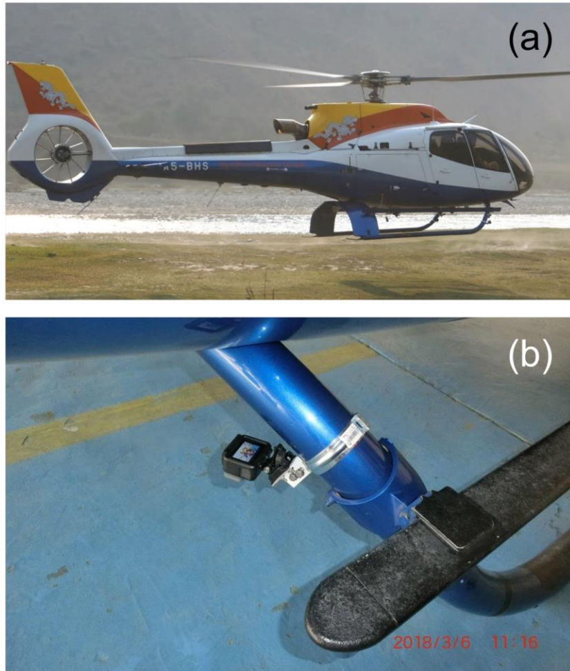
図 3.2 (a) 空撮に使用したヘリコプター、(b) ヘリコプターの脚部に取り付けたアクションカメラ (GoPro HERO5)。
