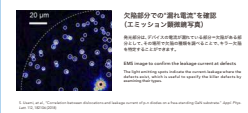
欠陥部分の“漏れ電流”を確認 (電子顕微鏡写真) Defect detection of GaN crystals
