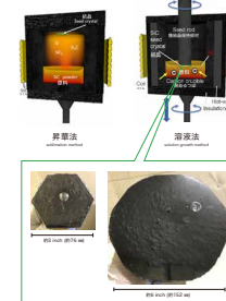
溶液法で作成した、高品質なSiC結晶の画像 Image of high-quality SiC crystals grown by solution method
