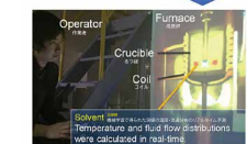
AIを用いた仮想実験の様子。AIによる仮想実験で炉内の温度・流速分布を予測することができました。 Appearance of a virtual experiment using AI. It was possible to predict the temperature and flow velocity distribution in the furnace using AI.
