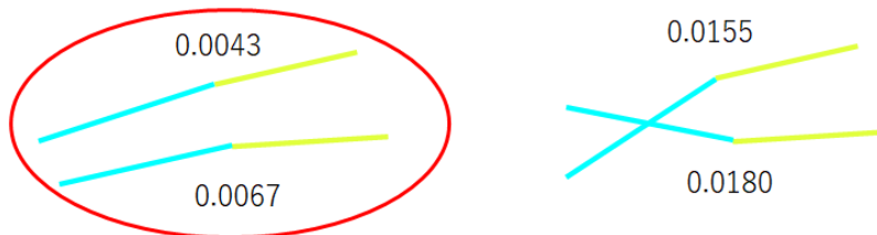
図 4.72: 完全 2 部グラフになっているまとまりの中からある完全 2 部グラフ部分に注目し接続の選択を行う。選ぶべき組み合わせを列挙し、各接続組み合わせに対して角度差の和を指標として良い接続を決定する。
