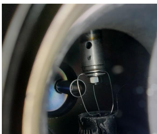
図 5.3 液体 SBLE 攪拌の様子
