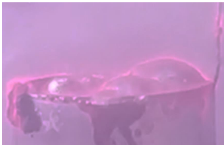
図 5.5 直流負バイアス電圧印加時の SBLE の発光
