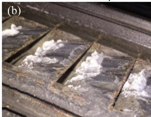
図 1-3 (a)タービン翼断面の概略図,(b)タービン翼へのスケール付着例
