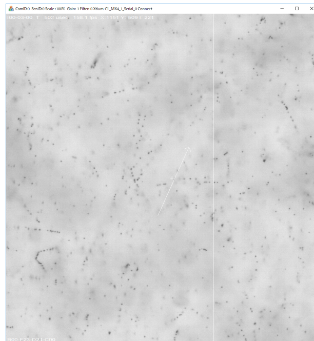
図 5.16: Camera Controller のリアルタイム映像。およそ 140\ \mu\text{m} \times 140\ \mu\text{m} が描画されている。中央の矢印付近に目標飛跡がある。
