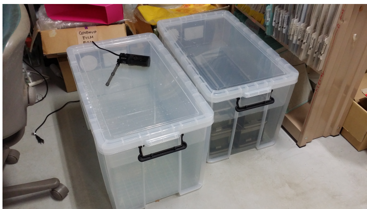
図 6.2: 膨潤中のフィルム。右の衣装ケースに水を溜め、ステンレス製のフィルムラックに収めたフィルムを浸している。この状態で半日待ち、その後左の衣装ケースのグリセリン溶液へと移す。
