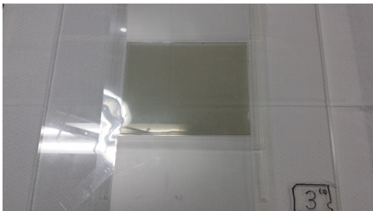
(a) アクリル板に掘られたガイドラインとフィルム角の位置が一致するように貼り付ける。
