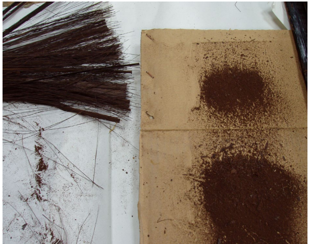
写真6 ゼファー機で分離した熱処理(蒸煮)竹の繊維と粉
