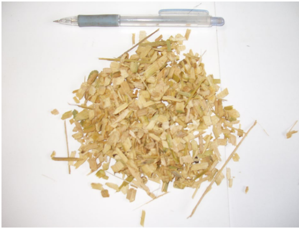
写真1 生竹のチップー機による破碎
