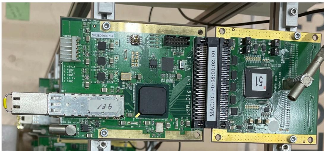
図 3.13: Kalliope Board。Open-It グループが開発したモジュール。プラスチックシンチレータの発光を、アンプと波高分別器を組み込んだ ASIC でデジタルパルスに成形し、TDC とマルチヒット保持用メモリを組み込んだ FPGA で時間情報を SiTCP TCP パケットに成形して、光イーサネット PC に送る。
