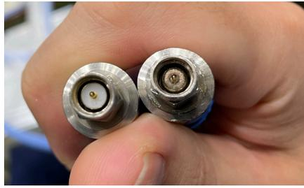
図 4.4: 左：摩耗していない SMA コネクタ。右：劣化した SMA コネクタ。コネクタの摩耗により絶縁体部分が金属粉に覆われている
