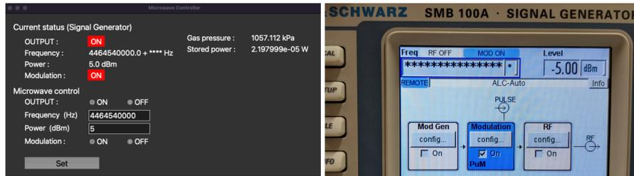
図 4.1: 左: マイクロ波制御用コンソールの画面。オフセット値はマスクされている。マイクロ波パワーや標的ガス圧もこの画面でモニターし、記録する。右: Signal Generator Rohde&Schwarz SMBV-B100A のフロントパネル。出力マイクロ波周波数はマスクされているため、実際の印加マイクロ波周波数を知ることはできない。
