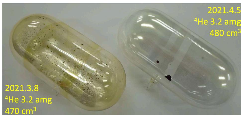
図 5.9: 試験用に製作した pyrex 製のセル。左: Rb 封入後、50 時間  $200^\circ\text{C}$  に加熱したもの。Rb によって腐食され、変色している
