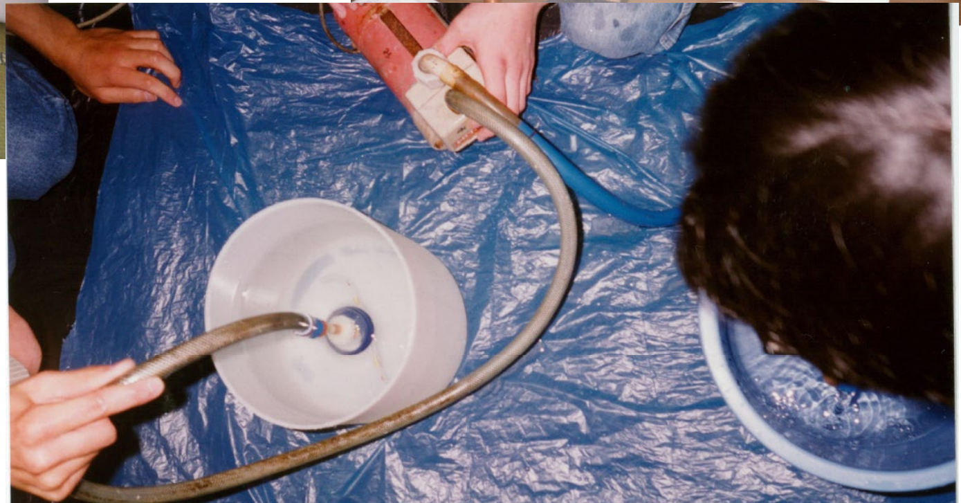
宿でインバース・スプリンクラー実験
