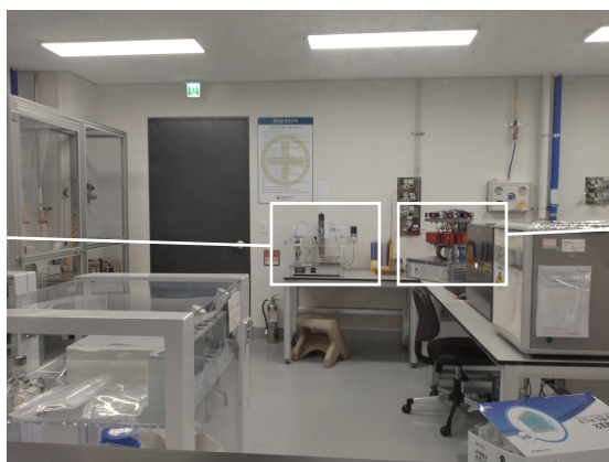
図2. 韓国国立文化財研究所の ^{14}\text{C} 試料調製室の様子 左側は、GC-MSに接続した自動サンプリングシステム、右側は、自動グラファイト装置 (AGE 3)
