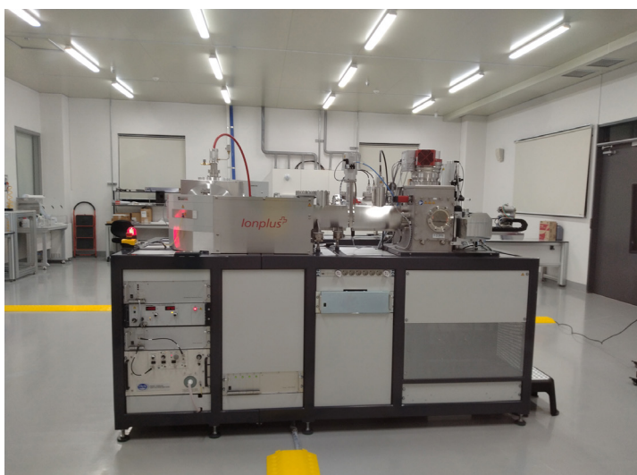
図1. 韓国国立文化財研究所に導入されたIonPlus社製の超小型 ^{14}\text{C} 測定専用AMS装置MICADAS 左側の写真は、AMS装置MICADASを制御するPC画面
