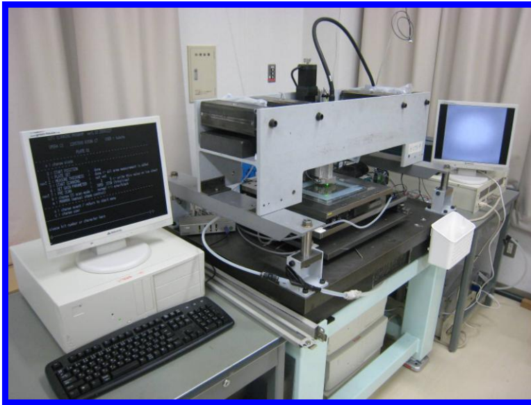
図 3-4-1、SUTS。フィルムをステージに置き、真空を引くことによってステージ上に張り付ける。油浸レンズを用いており、オイルが流れ出さないようにシリコンでフェンスを作ってスキャンしている。
