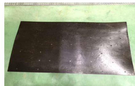
良好な平板成形品試作成功(保温システム導入)
