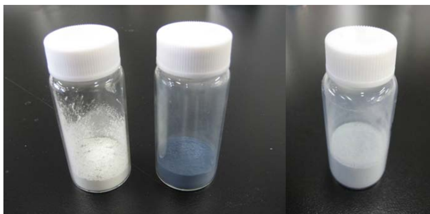
Fig. 3-9 左から、粉碎前、粉碎後、粉碎後→空気雰囲気下焼成後のMoO 3 粉体の外観写真
