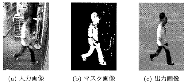
図 2 更新型背景モデルを用いた背景差分法の処理画像
