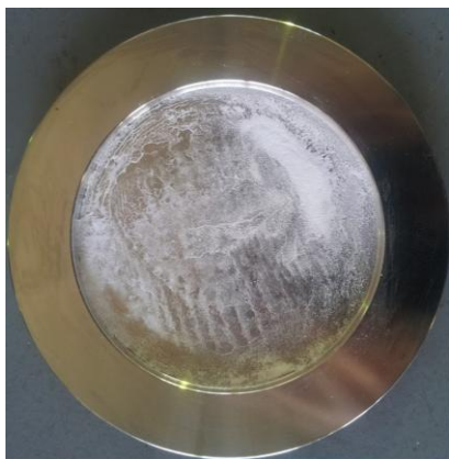
Fig.3-2 SrBr 2 無水物と反応器セル
