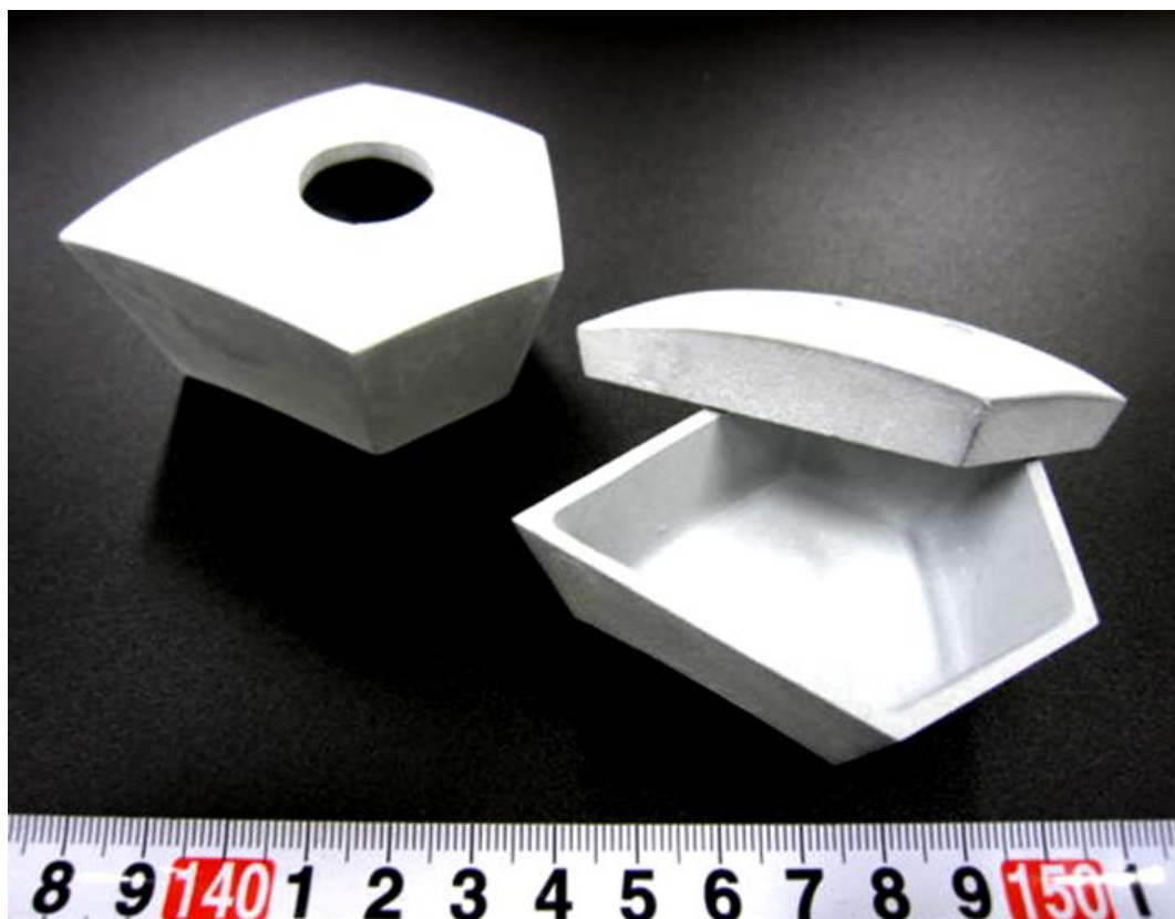
Fig. 2-23 スリップキャスト法および反応焼結法により無加工で作製した \text{Si}_3\text{N}_4 製五角中空ユニット（肉厚 3 mm）の外観
