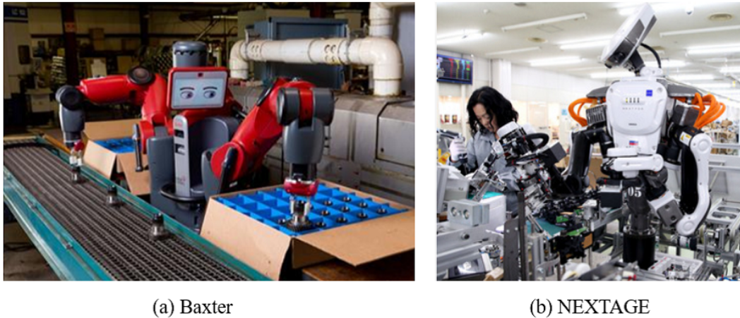
図 1.4: 製造ラインで活躍する人間型ロボット (出典: (a) http://www.nihonbinary.co.jp/ , (b) http://www.imart.co.jp/ )
