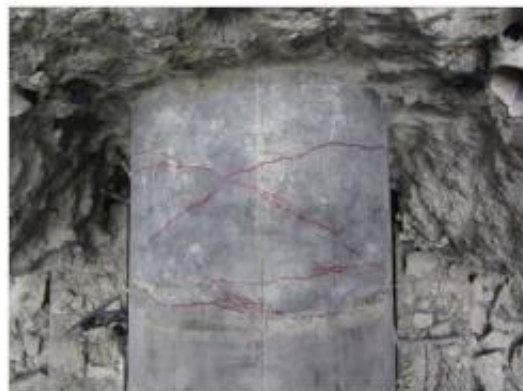
写真 4-3 スタブ内のひび割れ状況 2 (E-D300-1.5-T100C)
