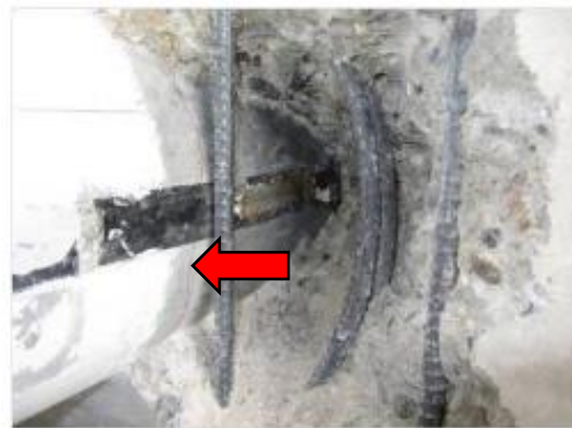
写真 4-2 スタブ内のひび割れ状況 1 (E-D300-1.5-T100M)
