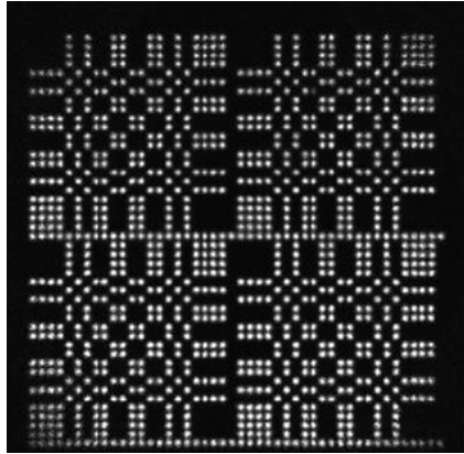
図 1-1-2 特定の開口パターンを持つコーデットマスクの一例 [6]
