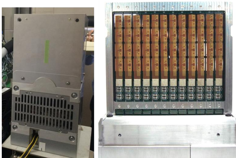
図 2-2-1 CdTe 半導体 3 次元アレイ検出器 (左)外観 (右)内部
