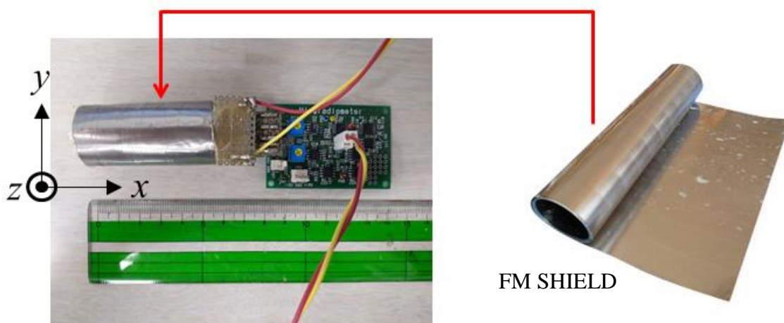
図 3.20 FM SHIELD を被覆したフィードバックコイル
