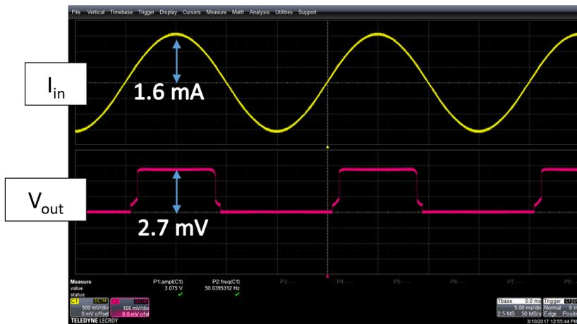
図 4.11 超伝導ダイオードによる半波整流
