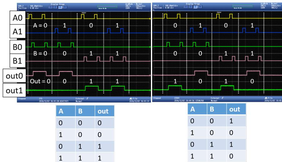
図 5.12 二線式 LUT の測定結果
