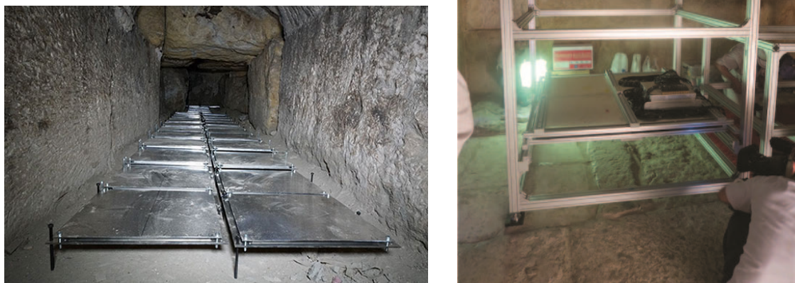
図 6.7: ピラミッド内に設置された原子核乾板 (左) とシンチレーターホドスコープ (右)
