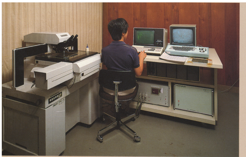
図 1.7: 全自動読み取り装置。左の装置が三鷹光器の大型ステージで、右側の机の下の左の箱がステージ制御用の DOMS、右の箱が飛跡認識のための Track selector
